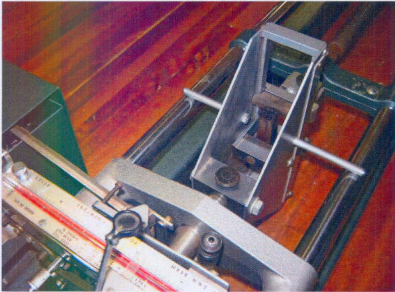
Figuur 4.11 Breeksterktetoets op geïmpregneerde houtmonster
