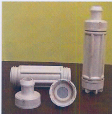
Figuur 4.4 Isco SFX220 superkritieke-fluïed-ekstraktor en reaksiehouers
