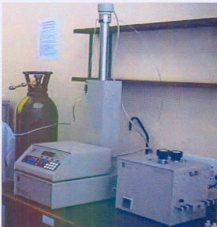
Figuur 4.4 Isco SFX220 superkritieke-fluïed-ekstraktor en reaksiehouers
