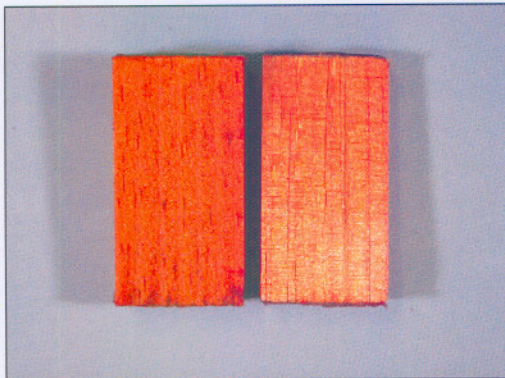
Figuur 3.6: sc\text{-CO}_2 impregnering met dispersgeel
