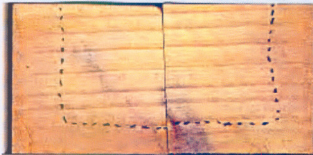
Figuur 3.1 Inforsering van harsoplossing
