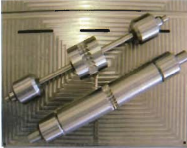
Figuur 14: Buigbare en rigiede rotors
